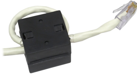
Figura 2-17: Installazione del blocco di ferrite
