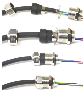
Figura 2-21: Installazione del pressacavo in metallo con la schermatura collegata
