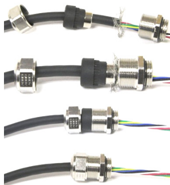
Figura 2-20: Instalación de casquillo metálico con cable blindado conectado
