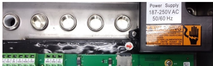
Figure 2-3 : Connecteur de l'alimentation CA avec couvercle
