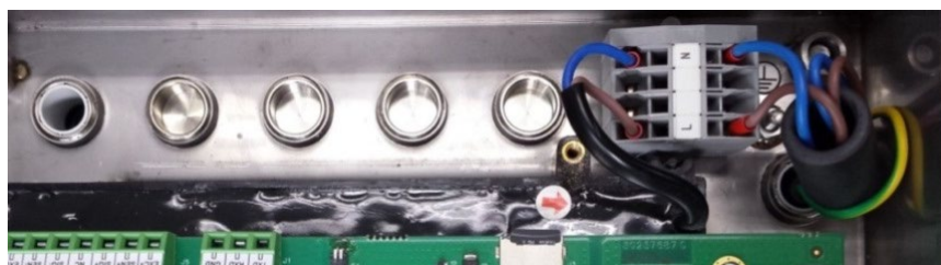
Figura 2-4: Connettore alimentazione CA con coperchio rimosso
