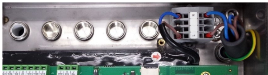
Figure 2-4 : Connecteur de l'alimentation CA sans couvercle
