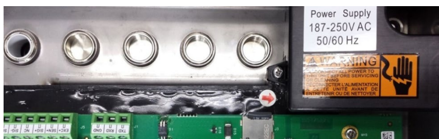
Figura 2-3: Connettore di ingresso alimentazione CA con coperchio
