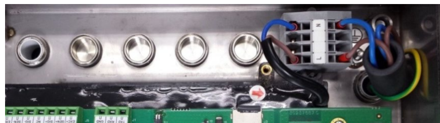
Abbildung 2-4: Netzstromanschluss ohne Abdeckung
