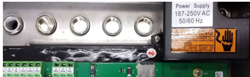
Abbildung 2-3: Netzstromanschluss mit Abdeckung
