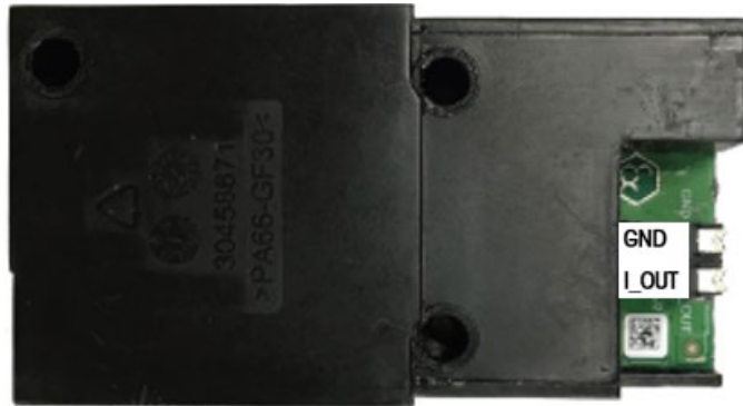
Figura 2-14: Placa de Opção de Saída Analógica Intrinsecamente Segura
