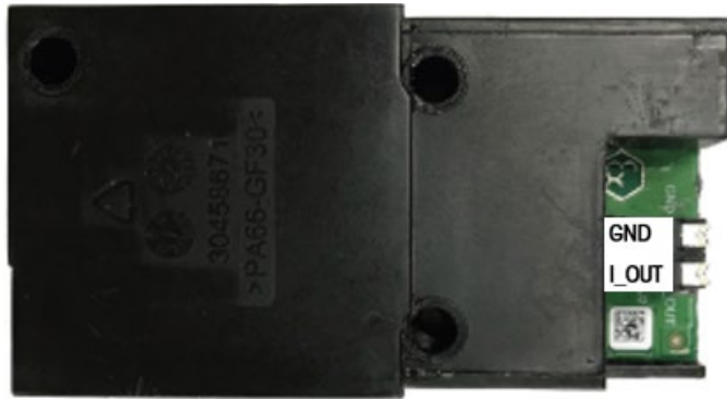
Figure 2-14 : Carte d'option de sortie analogique à sécurité intrinsèque
