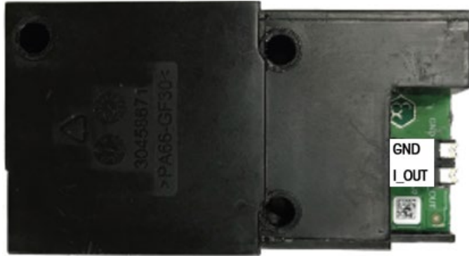
Abbildung 2-14: Eigensichere Optionsplatine für analogen Ausgang
