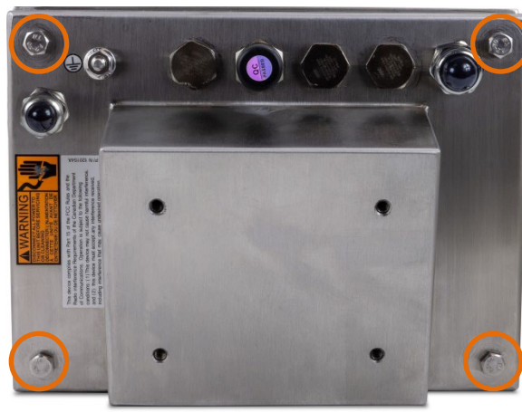
Figure 2-1 : Vis de l'enceinte
