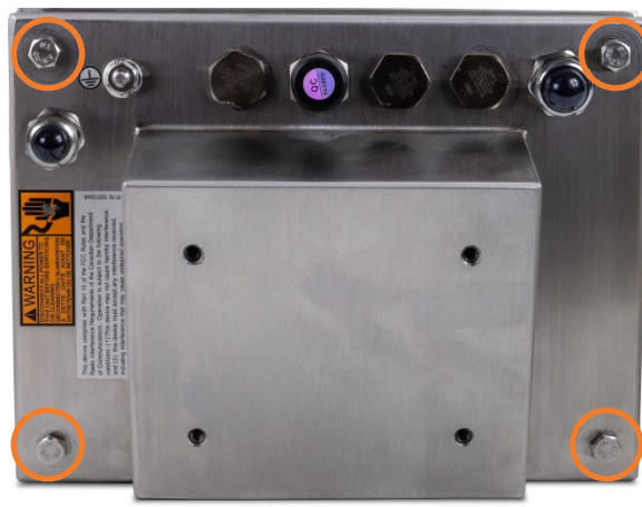
Figura 2-1: Parafusos do gabinete
