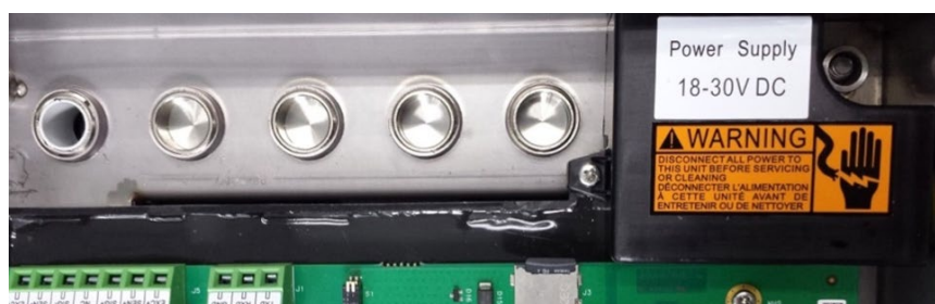
Figura 2-5: Connettore di ingresso alimentazione CC con coperchio
