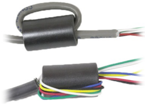
Figura 11: Envolve o cabo completo ou os fios individuais através da ferrite
