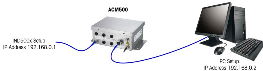
Fig. 72: Ejemplo: Configuración de la dirección IP (cruzada o con concentrador)
