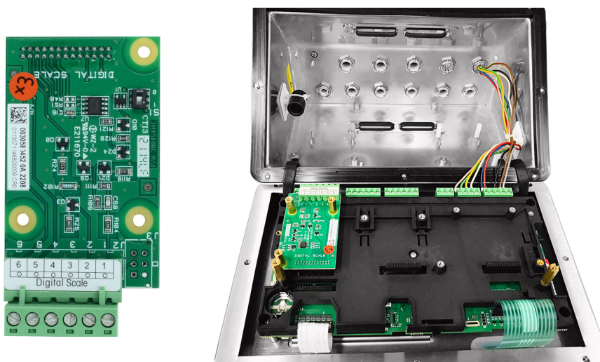
Fig. 28: Carte d’option de balance numérique pour la connexion de balances haute précision IDNet ou SICSPRO (gauche), installée (droite)
