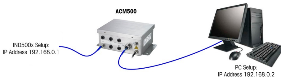
Fig. 72: Exemple : Configuration de l'adresse IP (Configuration du croisement ou du commutateur)
