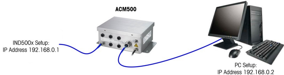
Abb. 72: Beispiel: IP-Adresskonfiguration (Crossover- oder Hub-Konfiguration)
