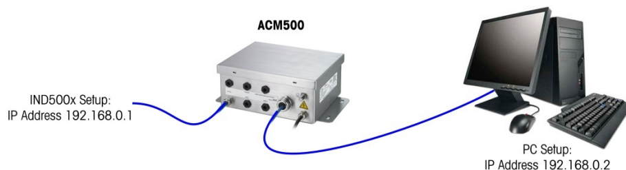
Figura 72: Exemplo: Configuração do endereço IP (configuração cruzada ou do hub)
