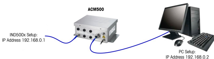
Figura 72: Esempio: Configurazione degli indirizzi IP (configurazione con cavo incrociato o hub)
