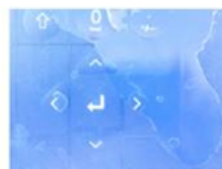
Couche antistatique endommagée. Remplacer
